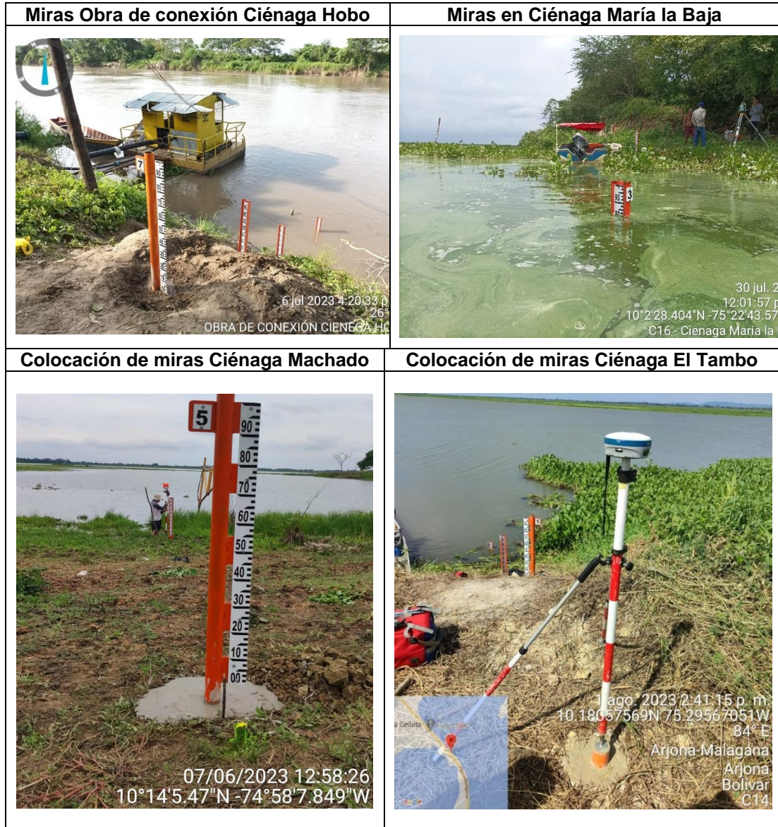
Fotografía 3. Instalación miras limnigraficas
